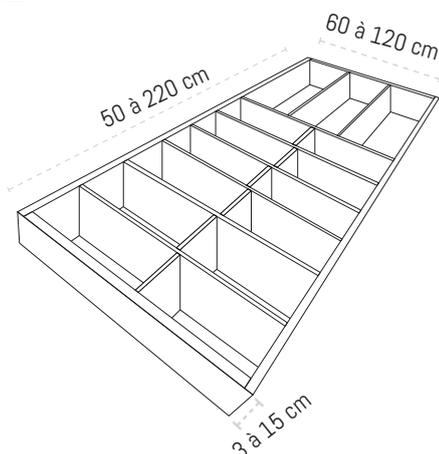
Nous préconisons la pose de nos receveurs de douche sur chape, dalle, ragréage ou sur une structure bois pour plus de simplicité. Nous pouvons fabriquer un socle en contreplaqué exotique stabilisé adapté aux dimensions de votre receveur et à la hauteur souhaitée.
